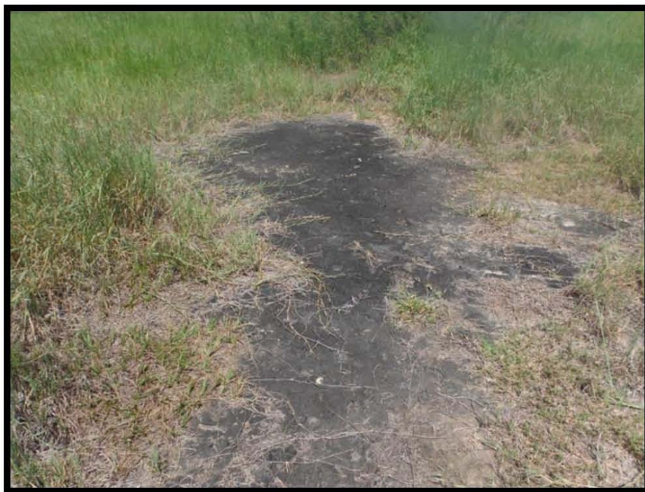
Fotografía 24.- Hidrocarburo intemperizado sobre derecho de vía X: 608737 Y: 2490945.
