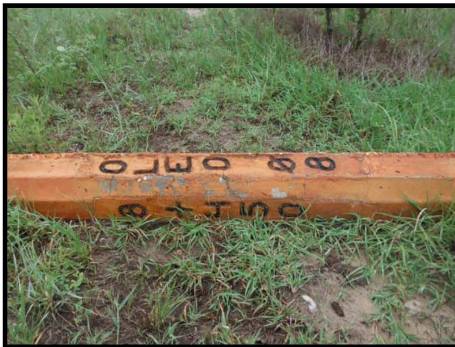
Fotografía 37.- Poste tipo R LDD 8" km 8+450 derribado, X: 609734 Y: 2488600.
